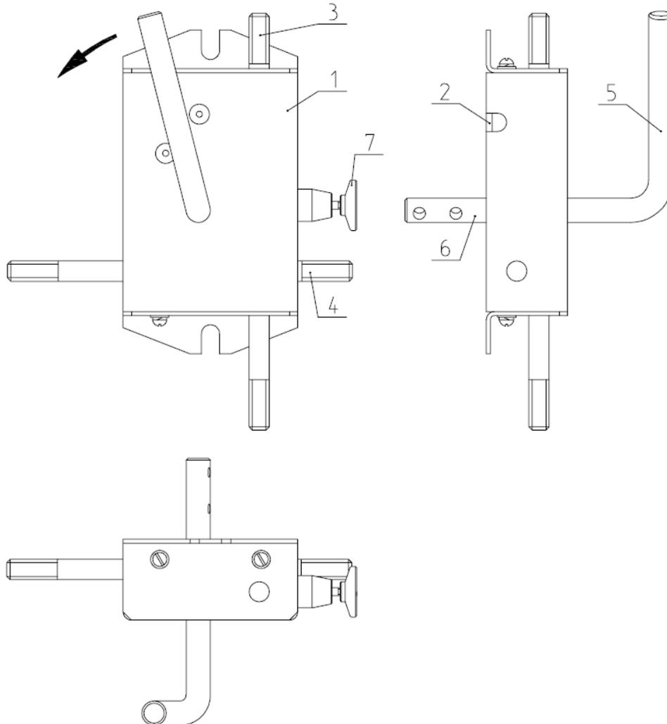
**Рис.4 Устройство блокиратора.**
