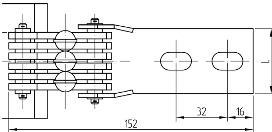
Рис.7 Габаритные и присоединительные размеры ламельных контактов 1000А.
